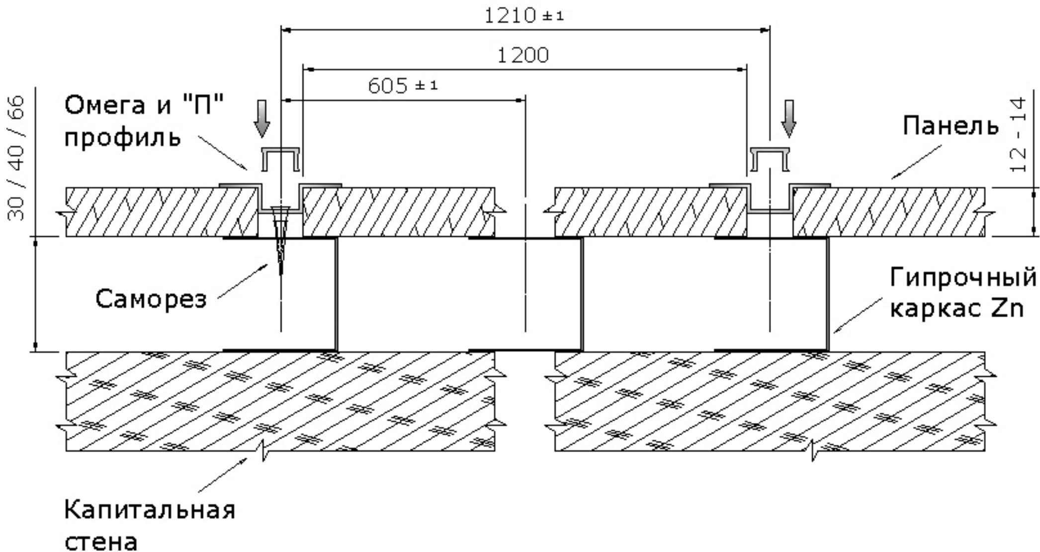
Примыкание к стене, полу, потолку.
